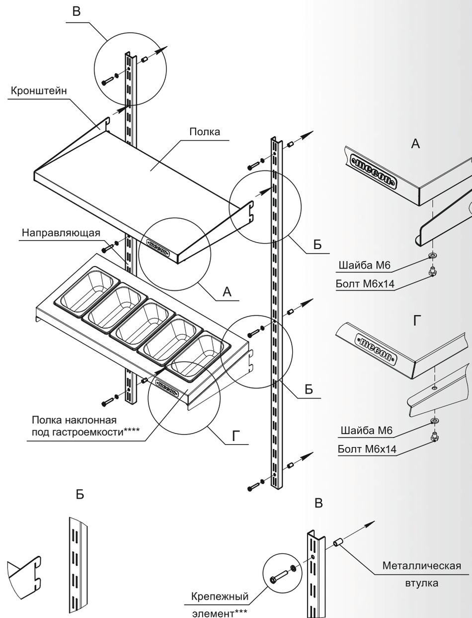
\*\* Пример сборки системы с переменной высотой с 1-й сплошной полкой/полкой наклонной под гастроемкости и 2-я направляющими
